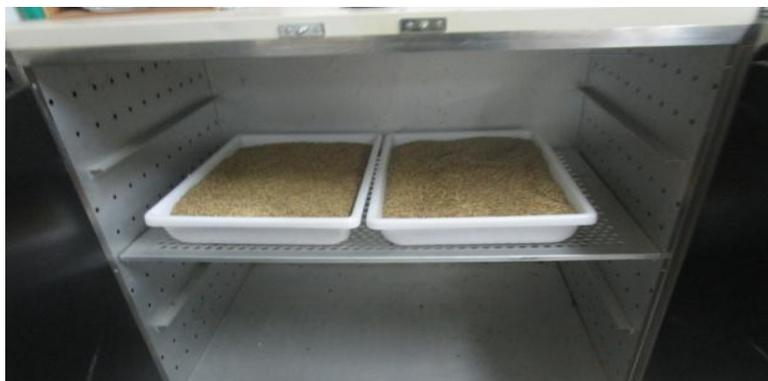
Figura 2. Ajuste de umidade das amostras em estufa de ar forçado (Quimis®, modelo Q314M293).
