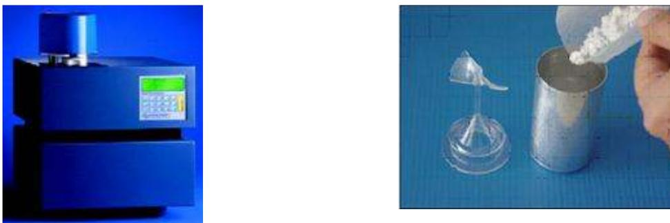
Figura 1 – Rapid Visco Analyser (RVA) e o modelo do canister utilizado para avaliar as amostras.
