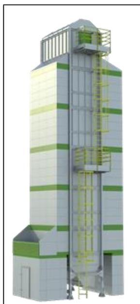
**Figura 9.** Secador de Multipla Intermitência utilizado para a secagem dos grãos de feijão carioca.
