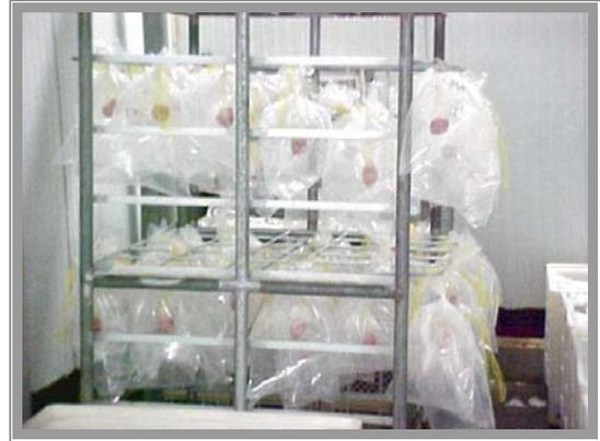
Figura 8: Suspensão das amostras para exsudação
