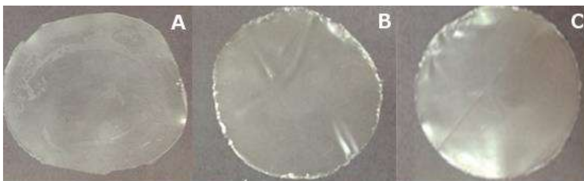
Figura 4 - Filmes obtidos a partir de solução filmogênica contendo 3% (m/m) dos amidos de mandioca nativo (A) e reticulados com diferentes concentrações dos agentes reticulante e alcalinizante (B – T1; C – T2), respectivamente, e 30% (m/m) de glicerol
