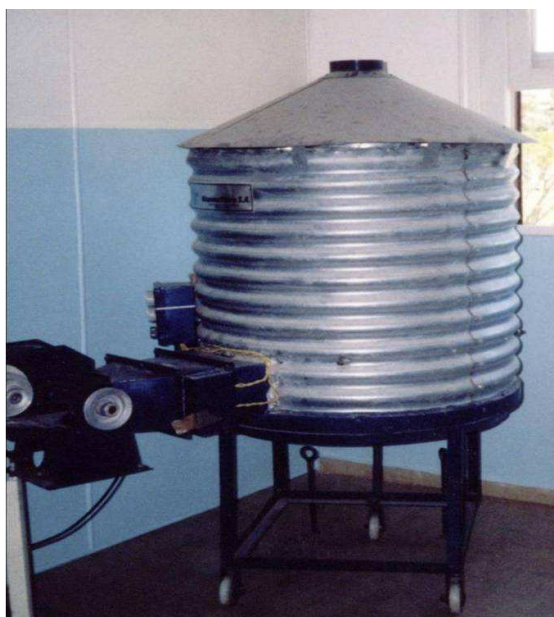
Figura 9 – Secador estacionário protótipo do Laboratório de Grãos.
