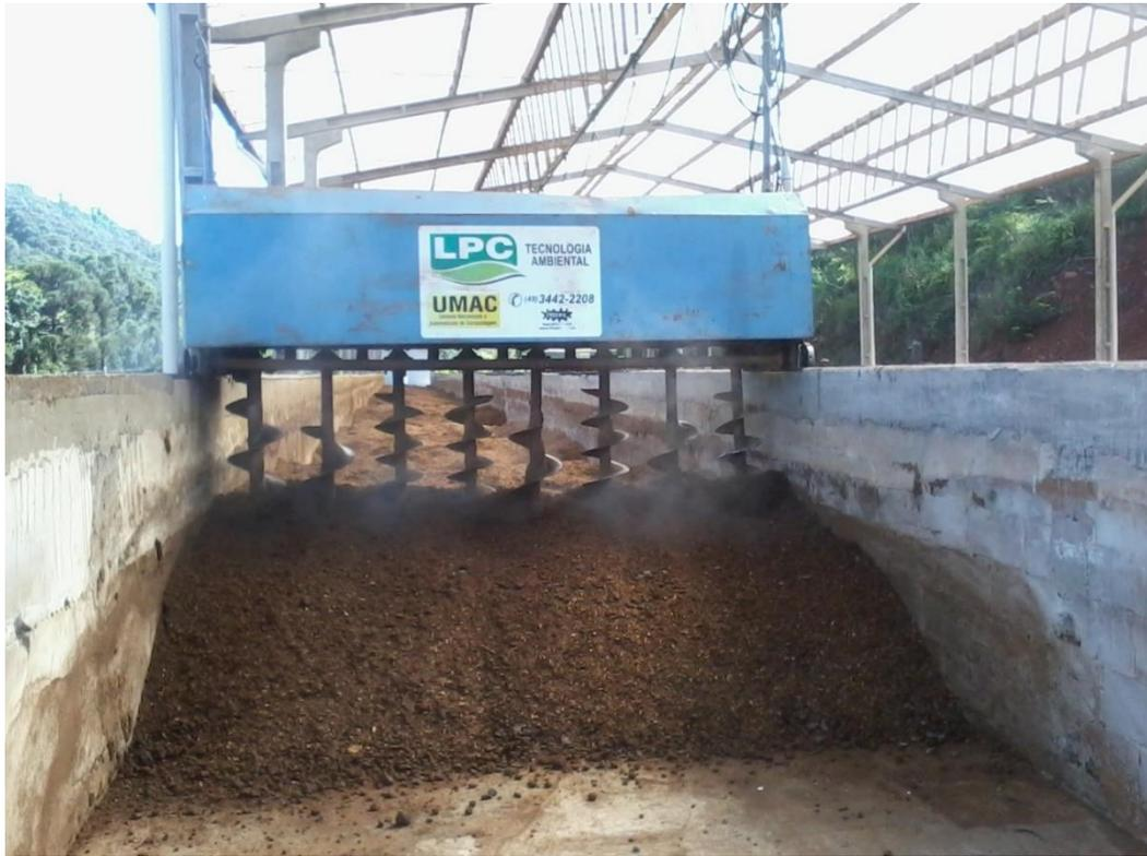
Figura 2: Revolvimento mecânico das leiras de compostagem
